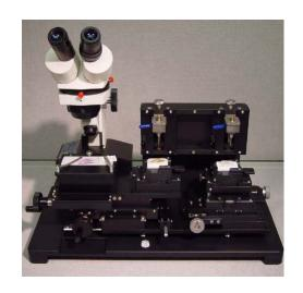
Veridiam 组织芯片仪能够在一个玻片上处理多个组织样本切片,该组织芯片仪在世界各国广为使用。我们的组织芯片仪提供构建高密度的组织芯片的工具,这样可以在一个玻片上处理高达 500个组织点。这不仅有助于研究者节省时间和资金,并且此高通量的检测技术能够为组织病理学提供可靠的结果。Veridiam 组织芯片仪 VTA-100 依靠自有的专利技术能够在一个玻片上通过多个组织片制作个性化的组织芯片。VTA-100 是世界上唯一一款在载物台和整合显微镜的组织芯片仪。三个位置通过 x-y 轴标记,此外这台仪器还引入了高度 Z 停留技术。
